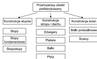
Rys. 2. Elementy prefabrykowane w budownictwie przemysłowym
