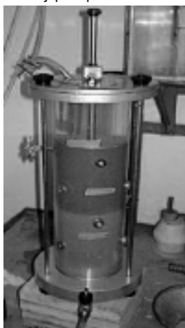
Fot. 2. Zmodyfikowany układ badawczy do badania przepuszczalności – na zdjęciu widać poziom wody, która przechodzi przez próbkę
