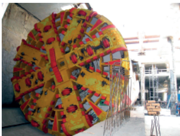
Fot. 4. Głowica tarczy EPB i urządzenia skrawające (dyski, noże) przed drążeniem tunelu
