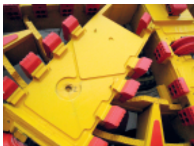
Fot. 3. Szczegół konstrukcyjny głowicy – widoczne noże skrawające, otwory do wprowadzania urobku do komory roboczej oraz dysze do iniekcji piany
