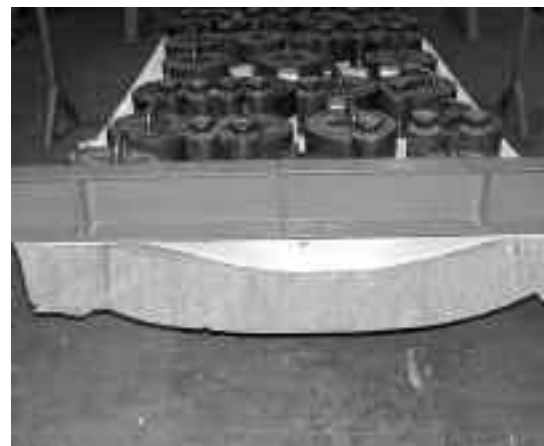
Ugięcie płyty warstwowej w kierunku poprzecznym, zamocowanej dwoma łącznikami na szerokości Fot. Autor
