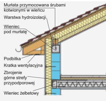
Wieniec pod murlatę w ścianie warstwowej
