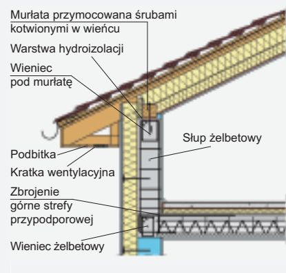
Wzmocnienie ściany kolankowej warstwowej
