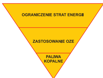
Rys. 1. Zasada „Trias Energetica”
