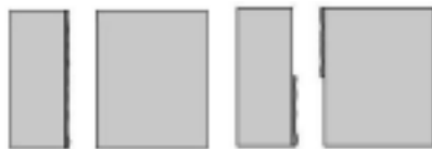
Rys. 4. Zniszczenie na skutek ścinania na styku elementu murowego/zaprawa na jednej powierzchni lub z rozdziałem na dwie części – typ A wg [3]
