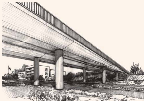
Tablica 4. OBIEKT 5410 – Wiadukt drogowy żelbetonowy jednojezdniowy, L = 74,30 m
