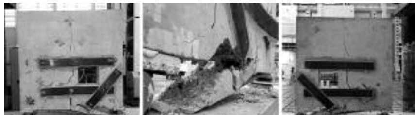
Fot. 1. Obraz zniszczenia tarczy wzmocnionej taśmami CFRP Photo 1. The failure view of deep beam strengthened with the CFRP strips
