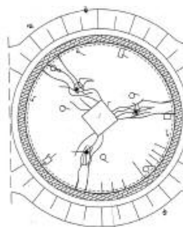
Rys. 1. Inwentaryzacja rys na płycie przekrywającej zbiornik o średnicy zewnętrznej 16,5 m, pokazany na fotografii 1
