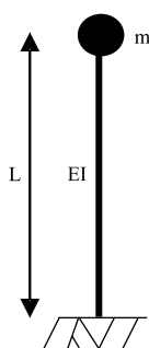
Rys. 1. Schemat zbiornika wieżowego o jednym stopniu swobody Fig. 1. Schema of water tower with single degree of freedom
