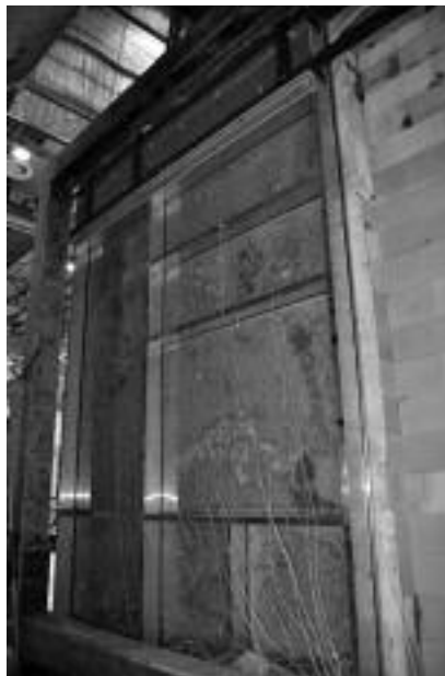
Fot. 2. Widok nienagrzewanej powierzchni elementu próbnego w trakcie badania odporności ogniowej w przypadku nagrzewania od zewnątrz
