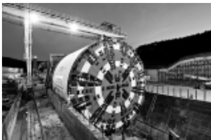
Fot. 1. Widok jednej z większych stosowanych na świecie tarcz TBM (Tunneling Boring Machines) o średnicy 15,50 m [9]
