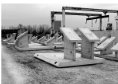
Fot. 3. Prefabrykowana ściana czołowa oraz skrzydełko z kotwami
