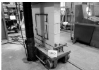
Fot. 2. Widok przykładowego modelu z bazą pomiarową umieszczonego w maszynie wytrzymałościowej
