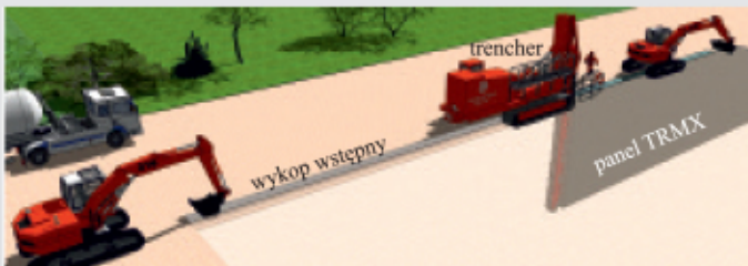
Schemat wzmacniania gruntu w technologii Trenchmix®
