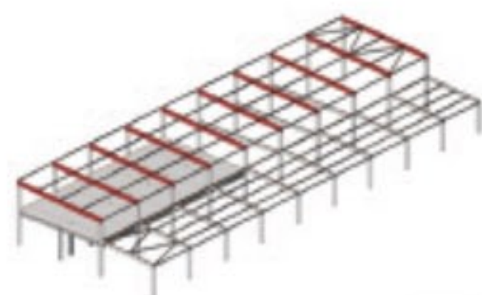
Rys. 2. Model fizyczny konstrukcji stalowej hali dwunawowej Fig. 2. Physical model of a steel structure of a double-edged hall
