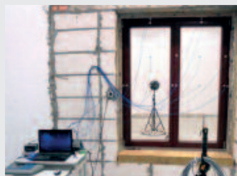
Pomiar drgań okna podczas badania izolacyjności akustycznej
