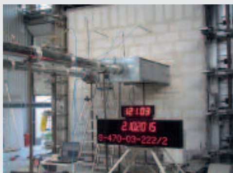
Badanie odporności ogniowej odcinających kłap przeciwpożarowych
