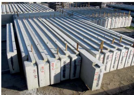
Warstwowe belki podwalinowe
