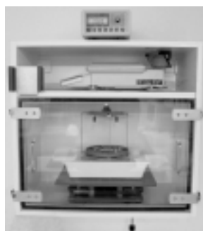
Rys. 1. Dane dotyczące absorpcji wody różnych typów materiałów oraz automatyczne urządzenie do pomiaru absorpcji wody opracowane wg [3; 7]
