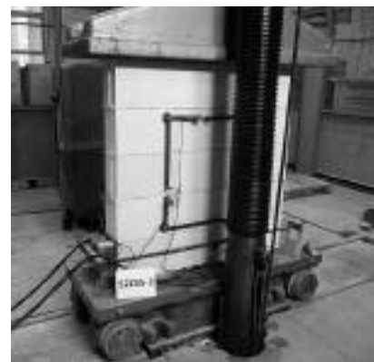
Fot. 1. Widok przykładowego modelu z bazą pomiarową umieszczonego w maszynie wytrzymałościowej
