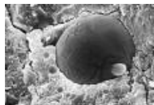
Fot. 6. Pojedyncze produkty hydratacji na ziarnie popiołu lotnego ODA, pow. 7300x
