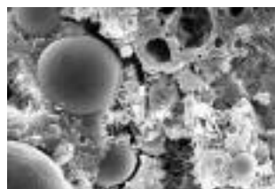
Fot. 4. Ziarno popiołu WZ otoczone fazą CSH w postaci żelowej, igielkowe formy ettringitu oraz widoczne płytkowe formy portlandytu, pow. 6600x
