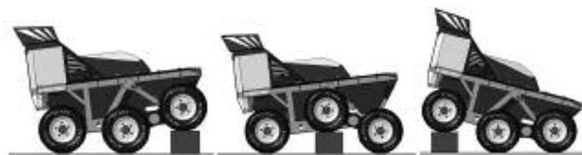
Rys. 6. Kolejne sekwencje pokonywania przeszkody terenowej typu „murek” przez platformę ExMot Fig. 6. Sequences of „block” obstacle overcoming by ExMot platform
