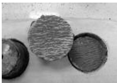
Fot. 2. Badanie przyczepności tynków renowacyjnych
