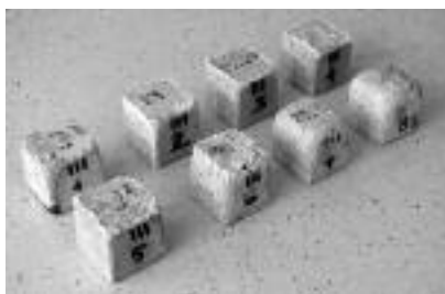
Fot. 1. Stan próbek tynków po badaniu odporności na zasolenie
