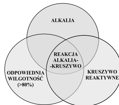
Rys. 1. Warunki występowania reakcji alkalicznej kruszywa
