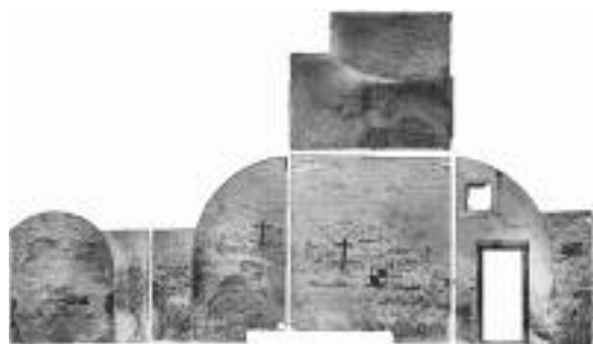
Fot. 2. Fragment ortofotoplanu z rzutami ścian i sklepienia wykonanego przez firmę Apply Capnor Poland na podstawie skanowania laserowego 3D
