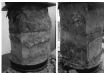
Fot. 5. Badanie wytrzymałości na ściskanie cegieł muru
