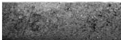
Fot. 2. Dolna powierzchnia podkładu (beleczka nr 2); niezagęszczony kompozyt jest bardzo porowaty
