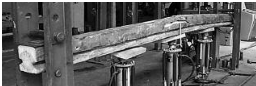
Badanie na zginanie drewnianej belki stropodachowej po 140-letnim okresie eksploatacji
