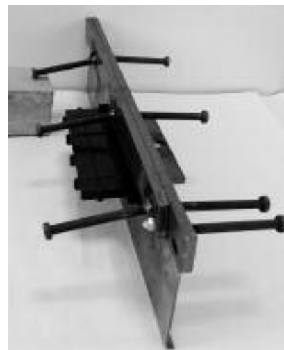
Fot. 2. System zabezpieczenia krawędzi z zastosowaniem dwóch płaskowników
