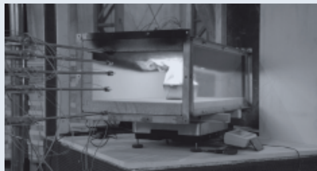
Badania w skali modelowej nad rozwojem pożaru w tunelu [4] Scale model research on the fire growth in tunnels [4]
