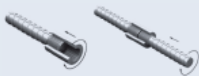
Rys. 3. Uciąganie prętów łącznikami w systemie BARTEC
