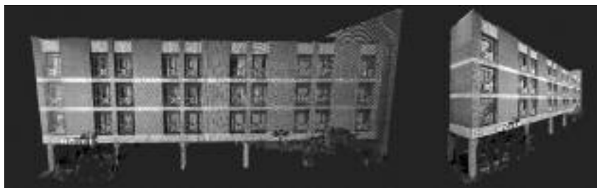
Rys. 2. Chmura punktów przedstawiająca elewację budynku hotelowego
