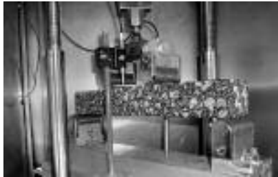
Fot. 1. Badanie pełzania statycznego 4BP
