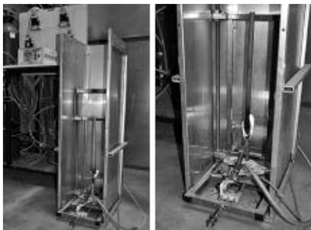
Fot. 2. Stanowisko do badania reakcji na ogień kabli elektroenergetycznych wg normy PN-EN 60332-1-2 w Laboratorium Badań Ogniwych Instytutu Techniki Budowlanej w Pionkach
