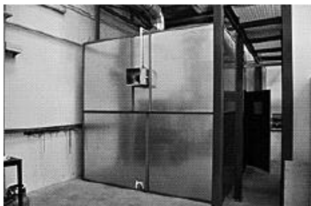
Fot. 3. Komora do badań gęstości dymu powstałego podczas badania kabli wg normy PN-EN 61034-1,-2
