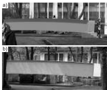
Fot. 1. Przęsło mostu stanowiące obiekt badawczy projektu FOBRIDGE: a – wizja architektoniczna; b – realizacja
