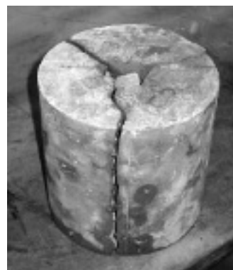
Photo 3. Failure modes of the double-punch specimen Fot. 3. Zniszczona próbkę walcowa
