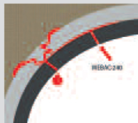
Schemat uszczelnienia konstrukcji tunelu
