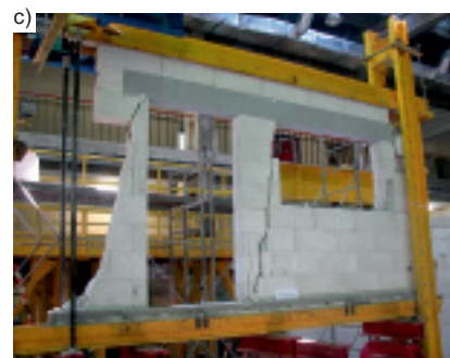
Widok ścian w chwili zniszczenia: a) ściana z otworem typu A, ściskana do wartości 0,1 \text{ N/mm}^2 ; b) ściana z otworem typu B, ściskana do wartości 0,1 \text{ N/mm}^2 ; c) ściana z otworem typu C, ściskana do wartości 0,50 \text{ N/mm}^2 View of the walls at the moment of destruction: a) wall with A-type opening, compressive stress of 0,1 \text{ N/mm}^2 ; b) wall with B-type opening, compressive stress of 0,1 \text{ N/mm}^2 ; c) wall with C-type opening, compressive stress of 0,50 \text{ N/mm}^2
