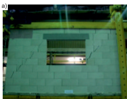
Widok ścian w chwili zniszczenia: a) ściana z otworem typu A, ściskana do wartości 0,1 \text{ N/mm}^2 ; b) ściana z otworem typu B, ściskana do wartości 0,1 \text{ N/mm}^2 ; c) ściana z otworem typu C, ściskana do wartości 0,50 \text{ N/mm}^2 View of the walls at the moment of destruction: a) wall with A-type opening, compressive stress of 0,1 \text{ N/mm}^2 ; b) wall with B-type opening, compressive stress of 0,1 \text{ N/mm}^2 ; c) wall with C-type opening, compressive stress of 0,50 \text{ N/mm}^2
