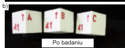
Fot. 1. Próbki ABK odmiany 400 o zawilgoceniu 30%: a) przed badaniem; b) po badaniu Photo 1. Freeze/thaw results of the samples AAC (density 400, moisture content 30%): a) before research; b) after research
