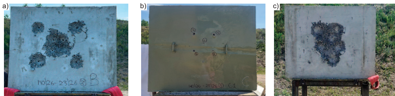
Elementy prefabrykowane po ostrzale amunicją kalibru 12,7 x 108 mm z pociskiem: a) B-32; b, c) symulującym odłamek artyleryjski FSP20 mm
