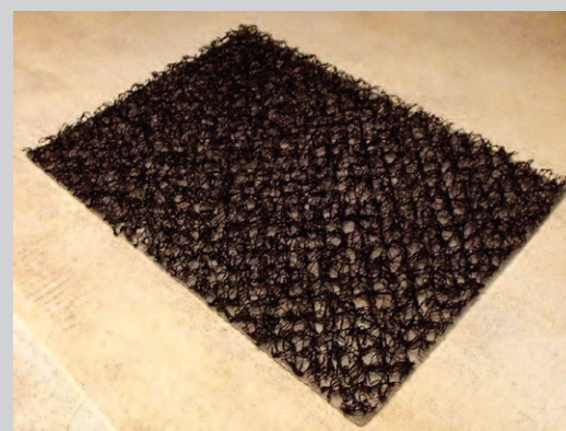
Fot. 1. Maty strukturalne są konieczne tylko pod pokryciami z blach cynkowych. Najlepsze działanie gwarantują maty dwuwarstwowe z przyklejoną wysokoparoprzepuszczalną membraną dodatkowo izolującą chemicznie i regulującą przepływ pary wodnej
