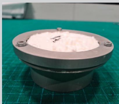
Fot. 2. Zestaw przygotowany do badań paroprzepuszczalności – dyfuzyjności pianki OKPUR, który składa się z miseczki i kołnierza dociskającego membranę do miseczki
