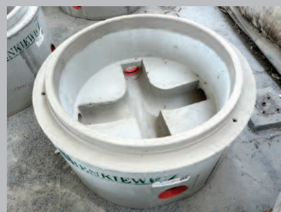
Fot. 3. Dennica studni z kinetą monolityczną
