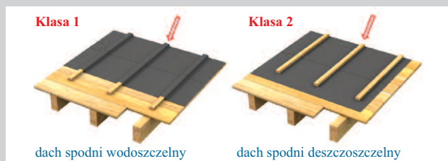
Rys. 1. W klasie 1 kontrłaty są uszczelnione warstwą hydroizolacyjną, a w klasie 2 taśmą piankową przyklejoną od spodu krokwi (lub klejem)
