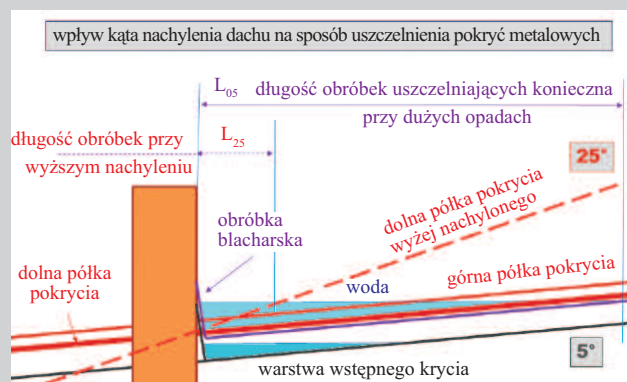
Rys. 6. Ten schemat pomógł zrozumieć, dlaczego na dachach o małym nachyleniu warstwa wstępna musi spełniać rolę hydroizolacji
