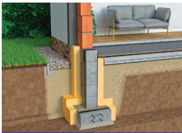
Termoizolacja ław fundamentowych
