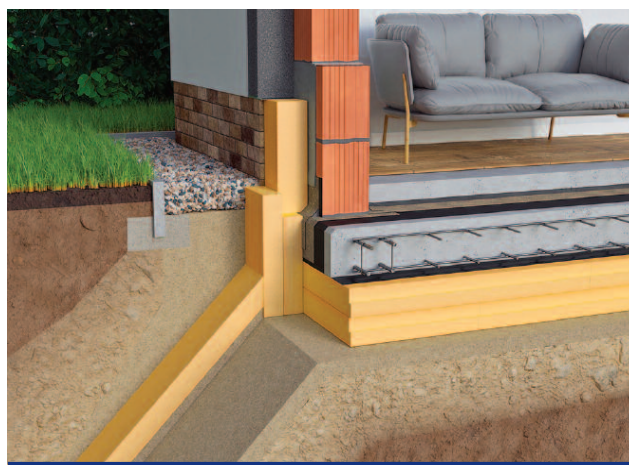
Termoizolacja płyt fundamentowych
