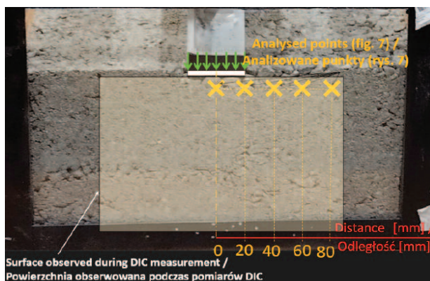
Photo 4. The research stand with the localization of analysed points Fot. 4. Stanowisko modelowe wraz z lokalizacją analizowanych punktów
