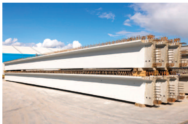
Fot. 1. Przykładowe belki mostowe typu T
