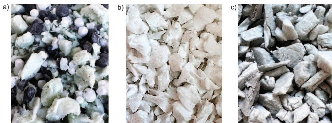
Photo 1. Structure of polystyrene regranulate particles: a) material A; b) material B; material C Fot. 1. Struktura cząstek regranulatu styropianowego: a) materiału A; b) materiału B; materiału C
