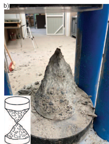
Fot. 3. Sposób zniszczenia próbek: a) błędna forma; b) prawidłowa forma. Schematy wg [2]
