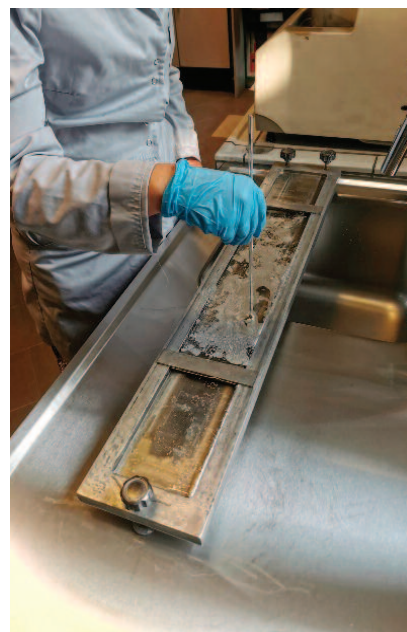
Fot. 2. Rozproszanie naważki na dostępnej powierzchni wyznaczonej przez ruchome sztabki
