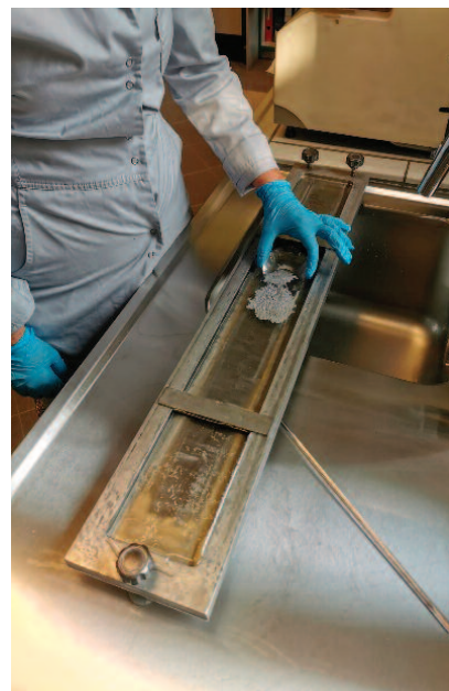
Fot. 1. Aplikacja naważki proszku aluminium na powierzchnię wody
